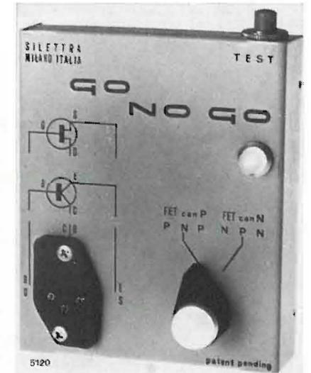
e può rilevare il guasto in transistori bipolari (NPN e PNP) ed in FET (a canale N ed a canale P), impiega una normale batteria di 4,5 volt, con una autonomia di diverse migliaia di ore ed è poco costoso. Il GO-NO-GO è prodotto e venduto dalla Società Eledra 3S di Milano. (1354)
